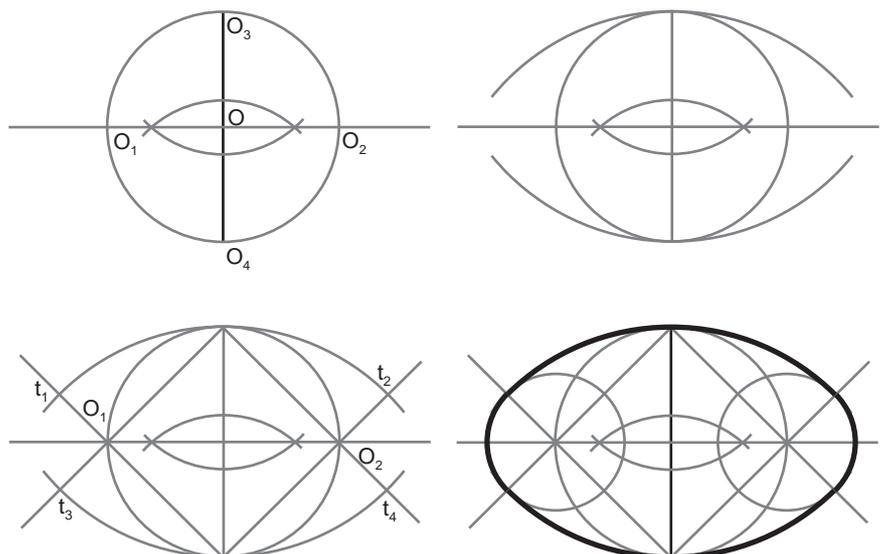
El óvalo es una curva cerrada y plana que está compuesta por cuatro, o más, arcos de circunferencia simétricos entre sí. Suele venir definido por dos ejes que marcan sus dimensiones y sirven de ejes de simetría de los arcos. Se emplea frecuentemente en perspectivas axonométricas para representar la circunferencia vista en perspectiva.
