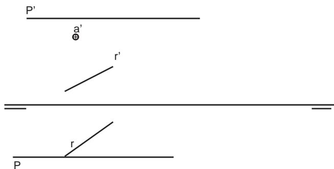
Determina el punto A contenido en el plano P que tiene 20 mm de cota y 10 mm de alejamiento.
