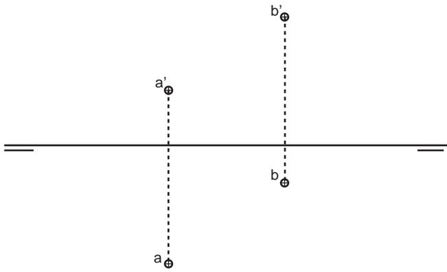
Determina las proyecciones de una recta horizontal, de cota 20 mm. determina también su traza, sabiendo que pasa por los puntos a y b, determina también las proyecciones verticales de a y b:
