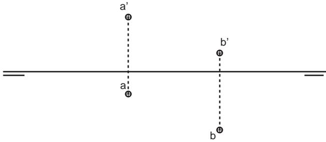
Dados los puntos A y B dibuja la recta que pasa por ambos y determina sus trazas:
