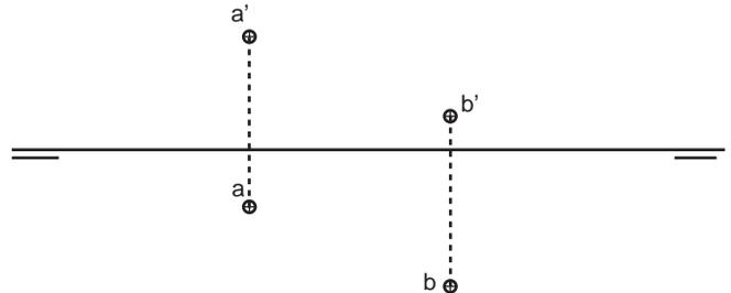
Dadas las proyecciones de la recta r, las de su traza vertical vv' y las proyecciones de un punto P (pp') perteneciente a ella se pide hallar la traza horizontal hh' de la recta r
