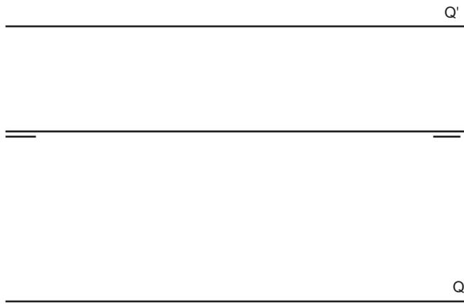
Dado el plano de perfil Q, determina una recta R de punta y una recta vertical S, ambas se deben cortar en un punto A, también perteneciente a Q, que tiene una cota de 15 mm. y un alejamiento de 5 mm. Por A traza una recta de perfil T que forma  $60^\circ$  con PH y  $30^\circ$  con PV y determina sus trazas.
