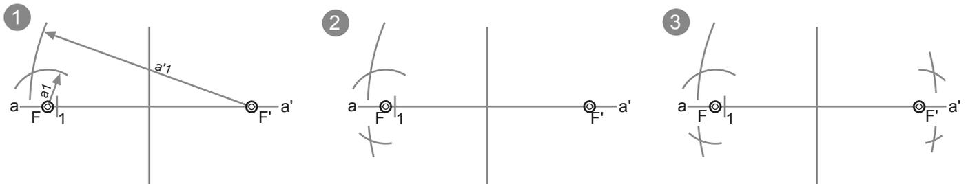
4º- Marcamos otro punto (2) sobre el eje mayor y repetimos la operación de los pasos 2º y 3º, así obtenemos otros cuatro puntos de la elipse
