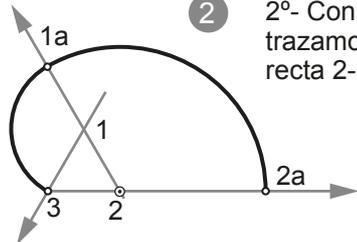
3º- Con centro en 3 y radio 3-2a trazamos un arco que corta a la recta 1-3 en el punto 3a.
