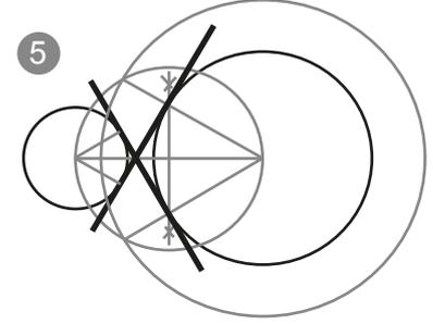
4º- Trazamos radios paralelos a los de la circunferencia grande en la circunferencia pequeña, pero invirtiendo su posición (el radio de arriba en la grande, abajo en la pequeña y viceversa). Los puntos de tangencia del problema original se encuentran en las intersecciones de los radios.
