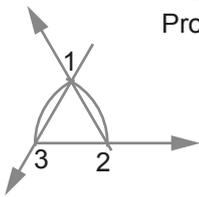
1º- Con centro en 1 y radio 1-3 trazamos un arco que corta a la recta 1-2 en el punto 1a.
