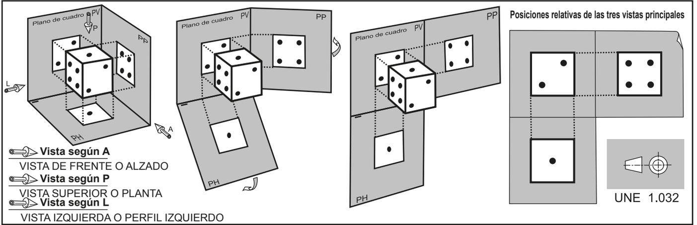
En la parte superior de la lámina se ha esquematizado el proceso de obtención y disposición de las tres proyecciones (vistas) ortogonales sobre el triedro trirectángulo, que determinan los planos principales (horizontal PH, vertical PV y de perfil PP).
